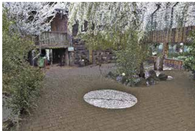
Ausschnitt aus der registrierten 3D-Punktwolke Abbildung: Gottschlich/Kühlwein
