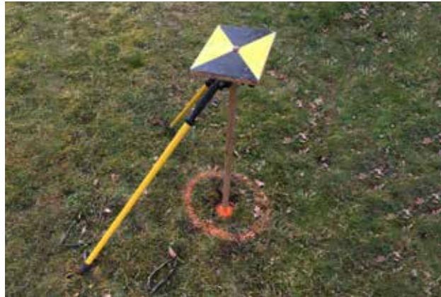
Bodenpasspunkt mit Schachbrettzielmarke Foto: Gottschlich/Kühlwein
