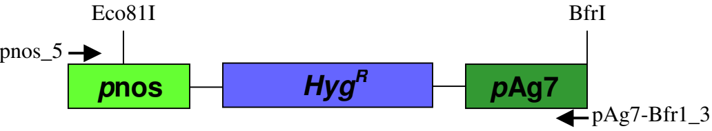
A.3. Hygromycin-Kassette im pBHTX -Vektor. Amplifiziert mit den angegebenen Primern zur Klonierung in den pHELLSGATE8 -Vektor (s. 2.2.18.).
