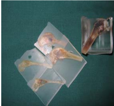
Abb. 3.6: Probe eingebettet in MMA mit 4 Knochen-schliffen
