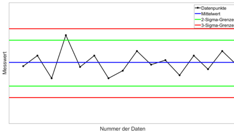
Schema 5: Aufbau einer Qualitätsregelkarte. Schwarz: experimentell bestimmte Werte, blau: Mittelwert aus den gemessenen Werten, grün: Warn- bzw. 2-Sigma-Grenze, rot: Eingriffs- bzw. 3-Sigma-Grenze.
