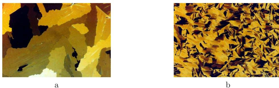
**Abbildung 3.24:** Texturen der Col<sub>rect</sub><sup>pmmn</sup>-Phase, Substanz **10e**, 132 °C; a: Mosaiktextur; b: fächerartige Textur nach Scheren der Mosaiktextur.
