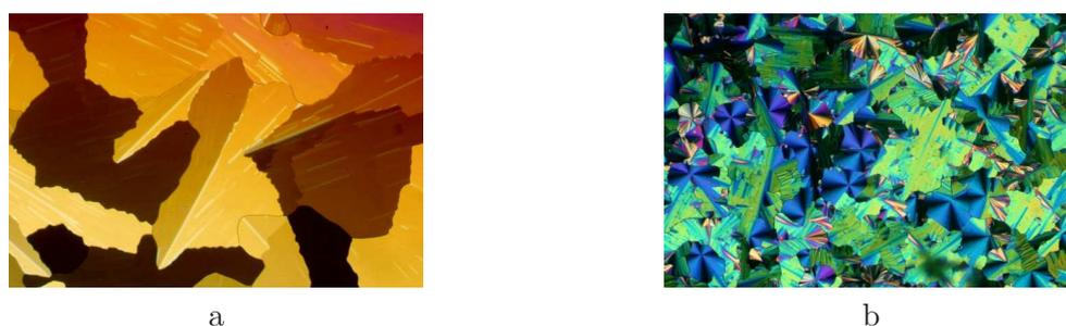
**Abbildung 3.60:** Texturen der Substanzen **27** (a) und **28** (b),  $Col_{rect}^{pmmn}$ -Phasen; a: Mosaiktextur, 125 °C; b: Mosaiktextur mit zirkularen Defekten, 120 °C.
