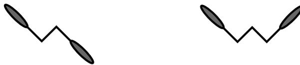
**Abbildung 1.2:** Einfluß des Spacer auf die Molekülform: Ein geradzahliger Spacer (*even*, linke Skizze) läßt bevorzugt eine lineare Anordnung, ein ungeradzahliger Spacer (*odd*, rechte Skizze) eine gewinkelte Anordnung der verbundenen Monomere als günstig erscheinen.
