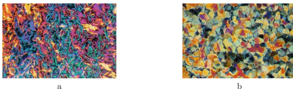
**Abbildung 3.46:** Texturen der Substanz **16a**; a: Schlierentextur, SmC-Phase, 236 °C; b: Mosaiktextur, SmX-Phase, 150 °C.
