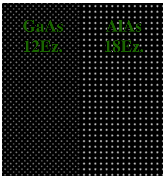
Abbildung 8.15: Simulierte Grenzfläche GaAs/AlAs mit Höhenunterschied 6 Ez.
