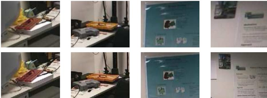
**Abbildung 3.12:** Oben sind einige ausgewählte Ausschnitte des Mosaikbildes aus Abb. 3.11 gezeigt, die im Vergleich zu den Originaldaten (unten) die gute Qualität des Mosaikbildes unterstreichen. Die Mosaikqualität nimmt allerdings bei großen Rotationswinkeln der Kamera deutlich ab (Bilder rechts).
