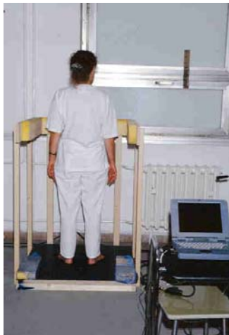
Abb. 2: Posturographische Versuchsanordnung; Anordnung der vier Fußplatten
