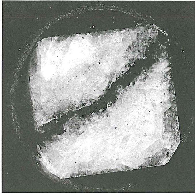
**Abb. 12:** Anschliff eines ca. 2 mm breiten Fahlerzbandes im reinen, weißen Schwerspat (Bildbreite 25 mm).
