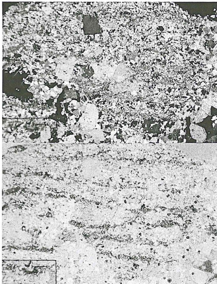
Abb. 4-20: Frühdiagenetisch laminiertes Anhydrit mit spätdiagenetischer Verdrängung durch Anhydrit und Dolomit. Anhydrit Typ III (Probe E11 der Bohrung Eldena 1/74, Werra-Anhydrit); (Balken = 320 µm, Aufnahmen oben mit gekreuzten Polarisatoren, unten Hellfeld).
