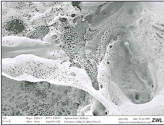
Abb. 28: REM-Aufnahme des bei 800°C (2h) gesinterten Precursors aus dem GNP; XRD-Diagramm in Abb. 25b
