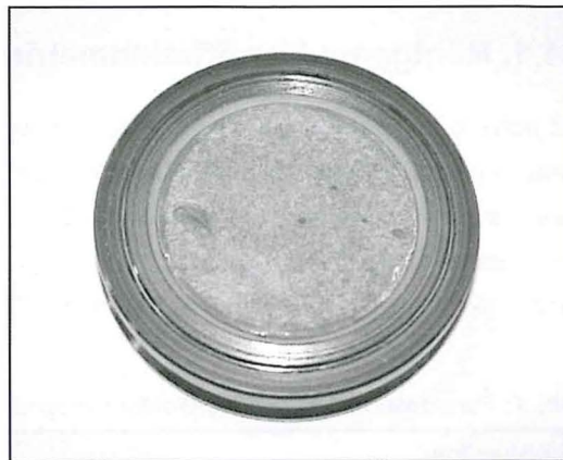
Abb. 6: Mit Zementpaste gefüllter Probenträger, der mittels einer Kapton-Folie verschlossen wurde
