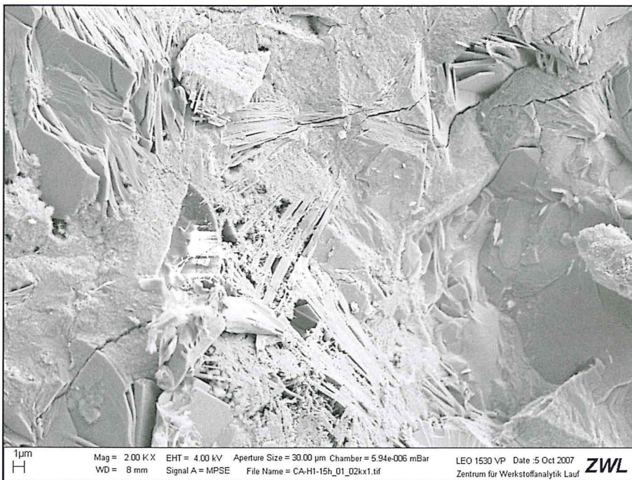
Abb. 115: Kryo-REM-Aufnahme von monoklinem CA, hergestellt mittels Festkörpersynthese; Hydratationszeit: 15h; W/F=2; vereinzelt sind lamellare Phasen beobachtbar, die röntgenographisch als C_2AH_8 und C_2AH_{7,5} identifiziert wurden
