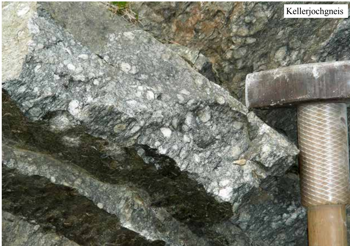
Abb. A-1: Augengneis Probe AB 76 in der Probenlokalität am Kellerjoch. Deutlich erkennbar sind die großen, hellen Augen aus Kalifeldspat in der feinkörnigen, dunklen Grundmatrix. Die Höhe des Hammerkopfes beträgt 3,5 cm.
