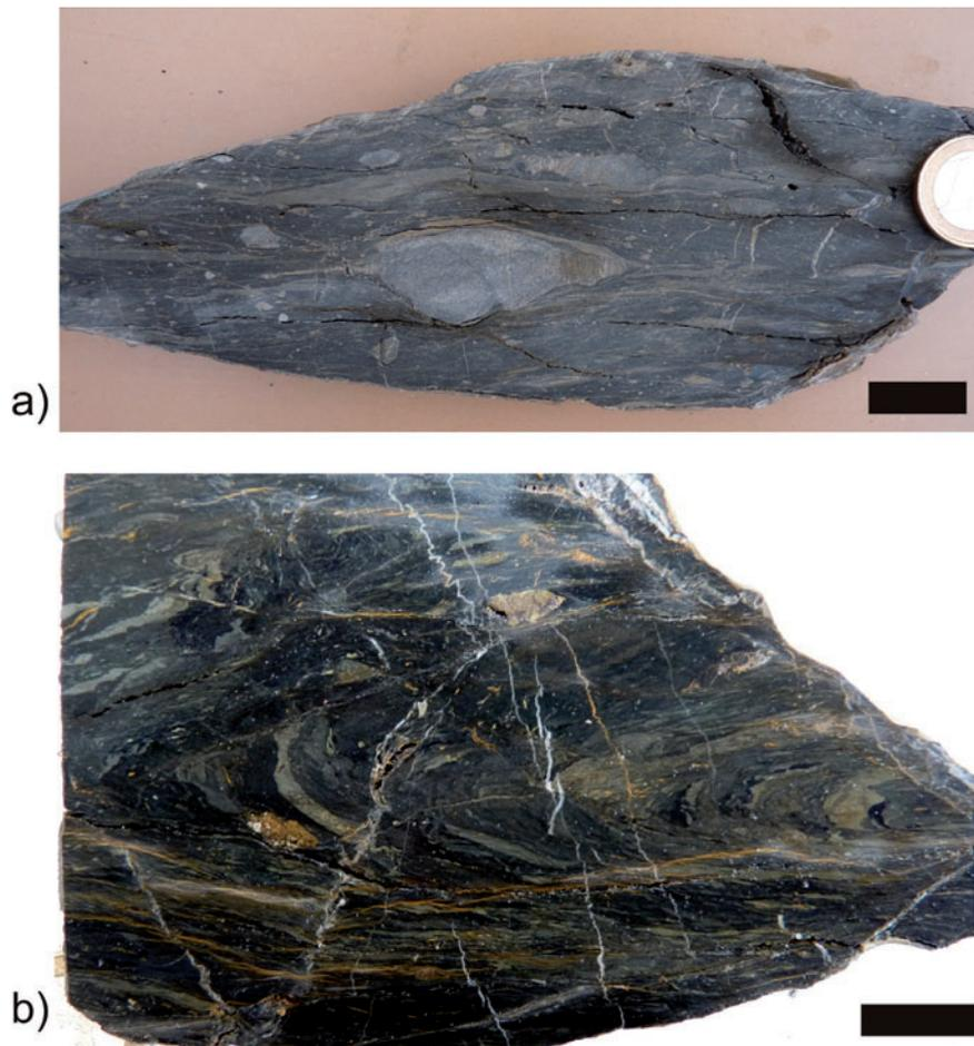
Abb. 15 Anschliffe von Proben aus dem Frankentaler Bimrockvorkommen. Die Klaster sind linsig deformiert und schieferungsparallel geregelt. Schichtinterne Verfaltungen wie in Abb. 15 b) weisen nicht auf eine frühe Rutschung, sondern sind erst im Zuge der Schieferung entstanden. Die Schieferung ist horizontal, Maßstab: 2 cm
