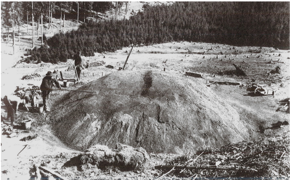
Abb. 16 Köhler bei der Arbeit an einem Platzmeiler im Harz. Foto um 1900 (nach HERMANN-REDDERSEN-Stiftung 2008, 5).
