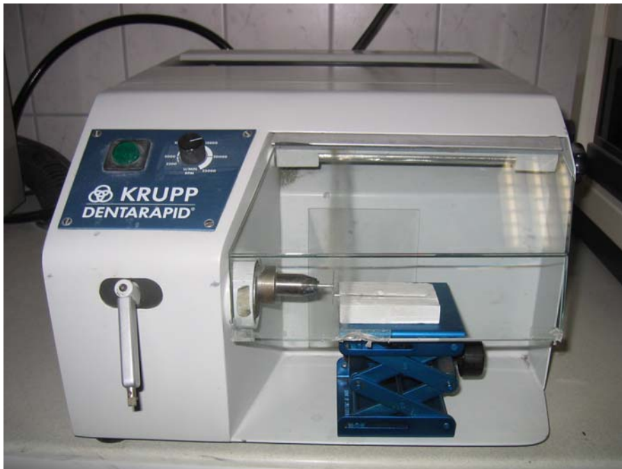
Abb. 6: Die Schleifmaschine Dentarapid wurde zum Begradigen der Drähte genutzt.
