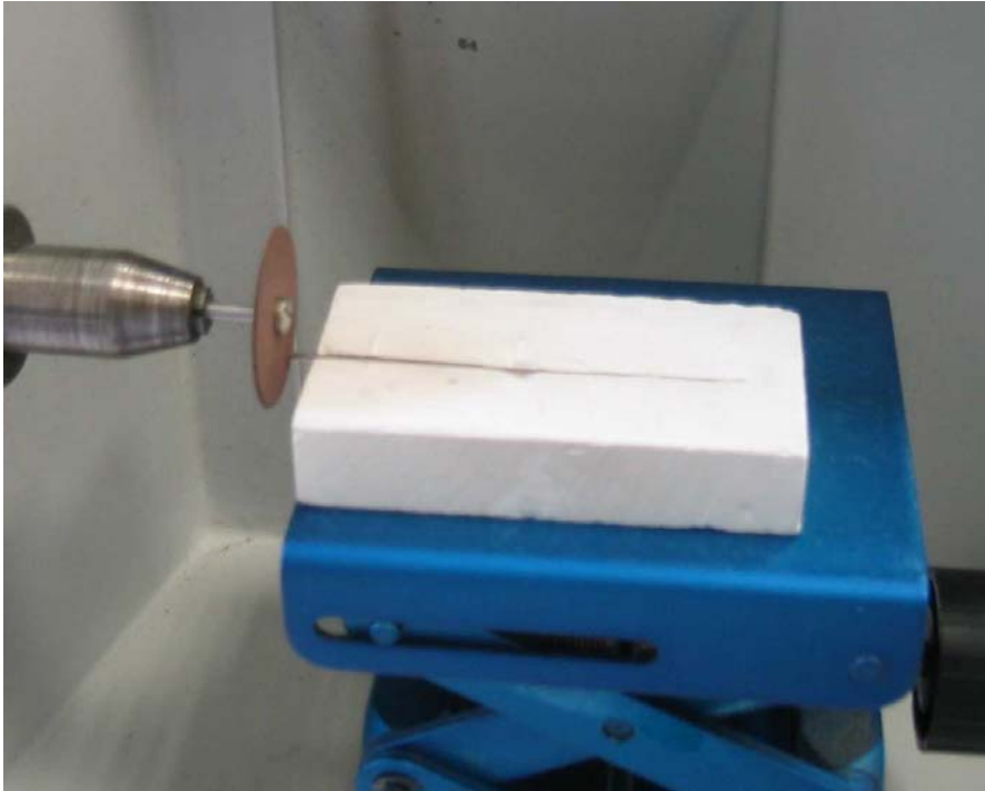
Abb. 7: Detailansicht - Gipsblock mit Führungsrille sowie Schleifscheibe
