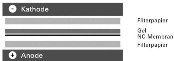
Abbildung 4: Sandwich-Aufbau beim Semidry Blotting
