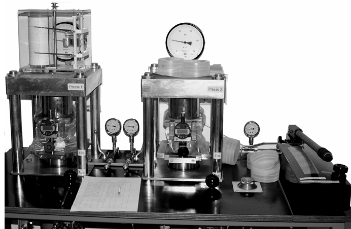
Abbildung 24 Verwendete manuelle hydraulische Kriechpresse.
