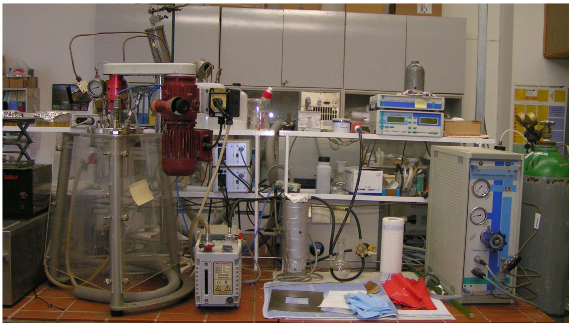
Abbildung 4.1: Foto der eingesetzten Polymerisationsapparatur mit Thermostat (links), Rührer und Gasdosierung (rechts)
