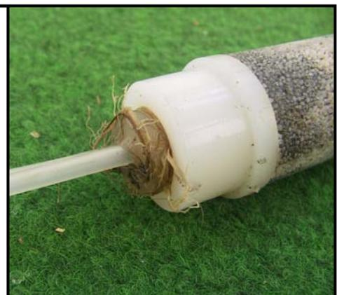
Abb. 3-7: Ausgebaute Kunststoffkerze
