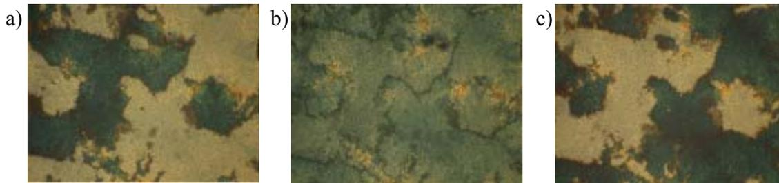
**Abbildung 84:** a), b), c) Polarisationsmikroskopische Aufnahme der Textur der  $\text{SmCP}_F^{[*]}$ -Phase von **Den-4**; Polarisator und Analysator sind um a)  $+5^\circ$  und b)  $-5^\circ$  aus der gekreuzten Position ausgelenkt
