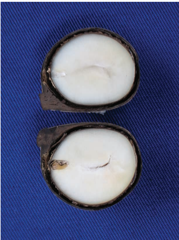
Abb. 6 Aufbau der Steinnuss mit mehreren Lagen und zentralem Hohlraum. Durchmesser einer Hälfte etwa 5 cm.
