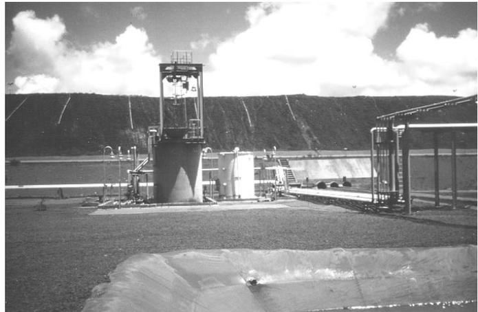
Abbildung 5: Anlage zur Goldgewinnung in der Mine Igarapé Bahia/ Carajás, Höhe des Turms ca. 5 m
