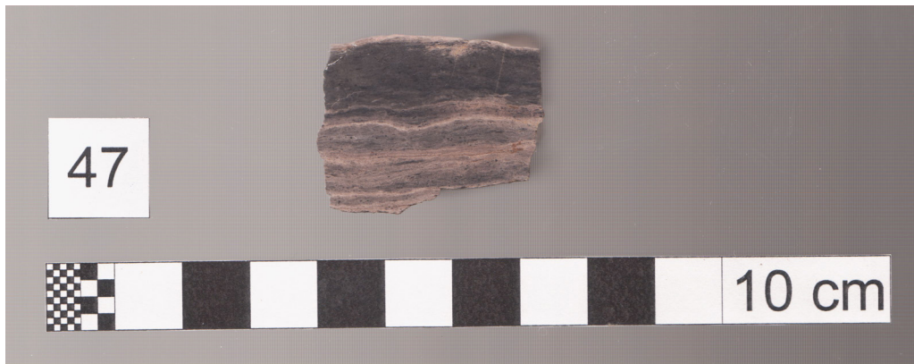
Abb. 14 LFT 9: Probe 47, Parzelle 16 Hornstein mit Warvenschichtung. Dunkle Segmente zeigen ein euxinisches, sauerstoffreiches Milieu an, die hellen Schichten ein sauerstoffreicheres. Im Allgemeinen sind Warvenschichtungen von Jahreszeiten beeinflusst.
