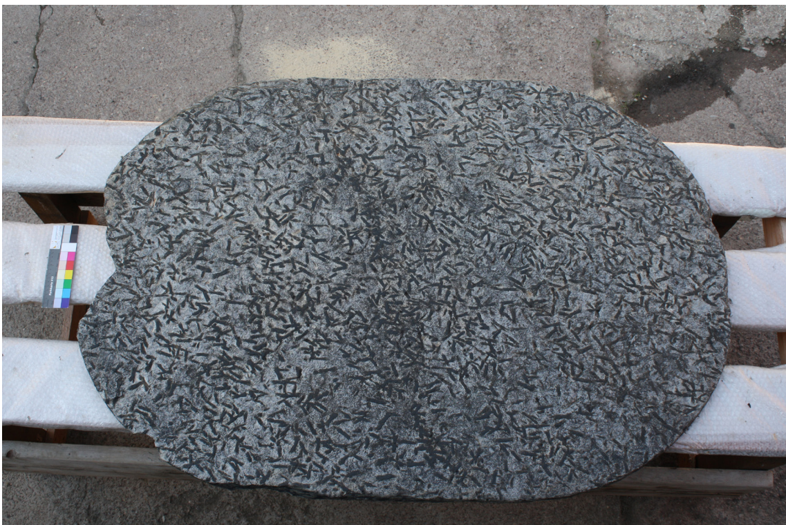
Abb. 3 Endzustand der Oberseite nach konservatorischem Oberflächenverschluss und Retusche der angeböschten Bereiche mit Gouachefarben und Reinpigmenten. Die Inschrift „P. Melanchton / 15[..]“ ist aufgrund der Lichtverhältnisse nicht zu sehen.
