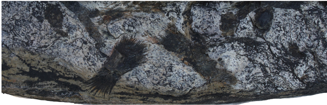
Abb. 7 Garbenförmige Kristallsprossung auf der gereinigten Tischplatte (vgl. BACHMANN & GLÄSSER 2015). Länge der Garben ca. 4 cm.
