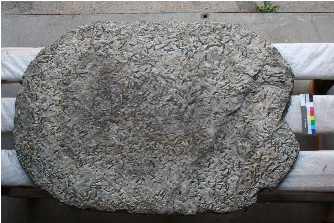
Abb. 4 Endzustand der Unterseite nach konservatorischem Oberflächenverschluss und Retusche der angeböschten Bereiche mit Gouachefarben und Reinpigmenten.
