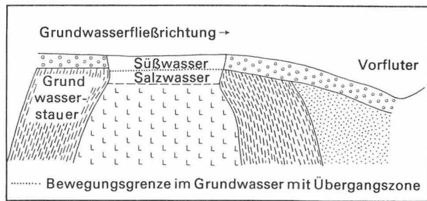
Abbildung 8 Auslaugungsfläche unterhalb der sie umrahmenden Grundwasserstauer (Position II)
