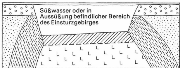
Abbildung 3 Prinzipskizze zur inaktiven Auslaugung bei Abdichtung der Auslaugungsfläche (s. Abbildung 1)
