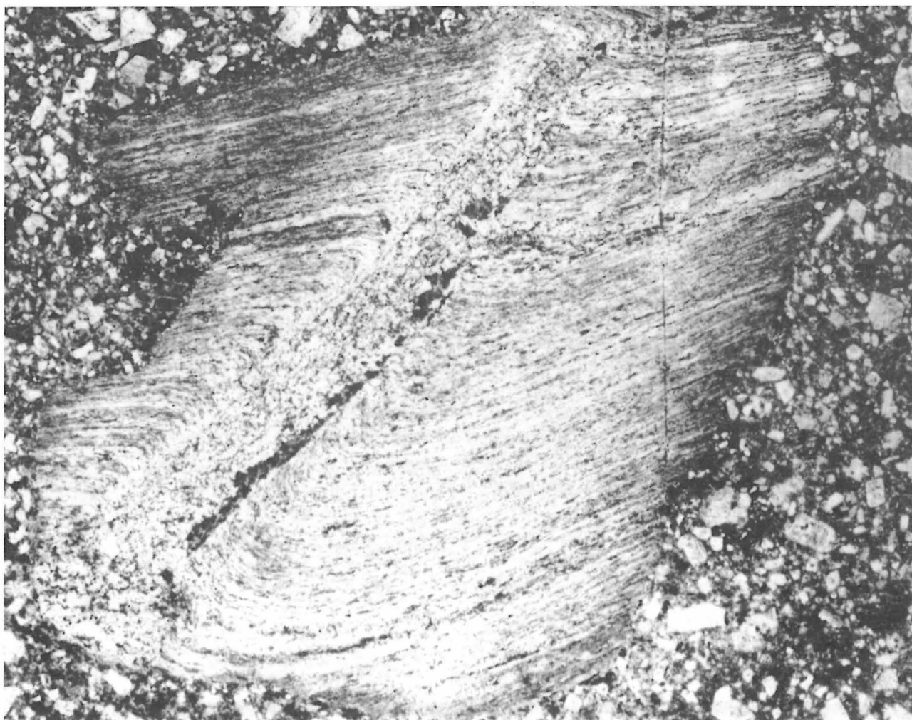
Photo 1 Orthoklas- und quarzreicher Xenolith mit fließfaltungsähnlichen Phänomenen und Mylonitzone im Pyroxengranitporphyr (Photo MARLE)
