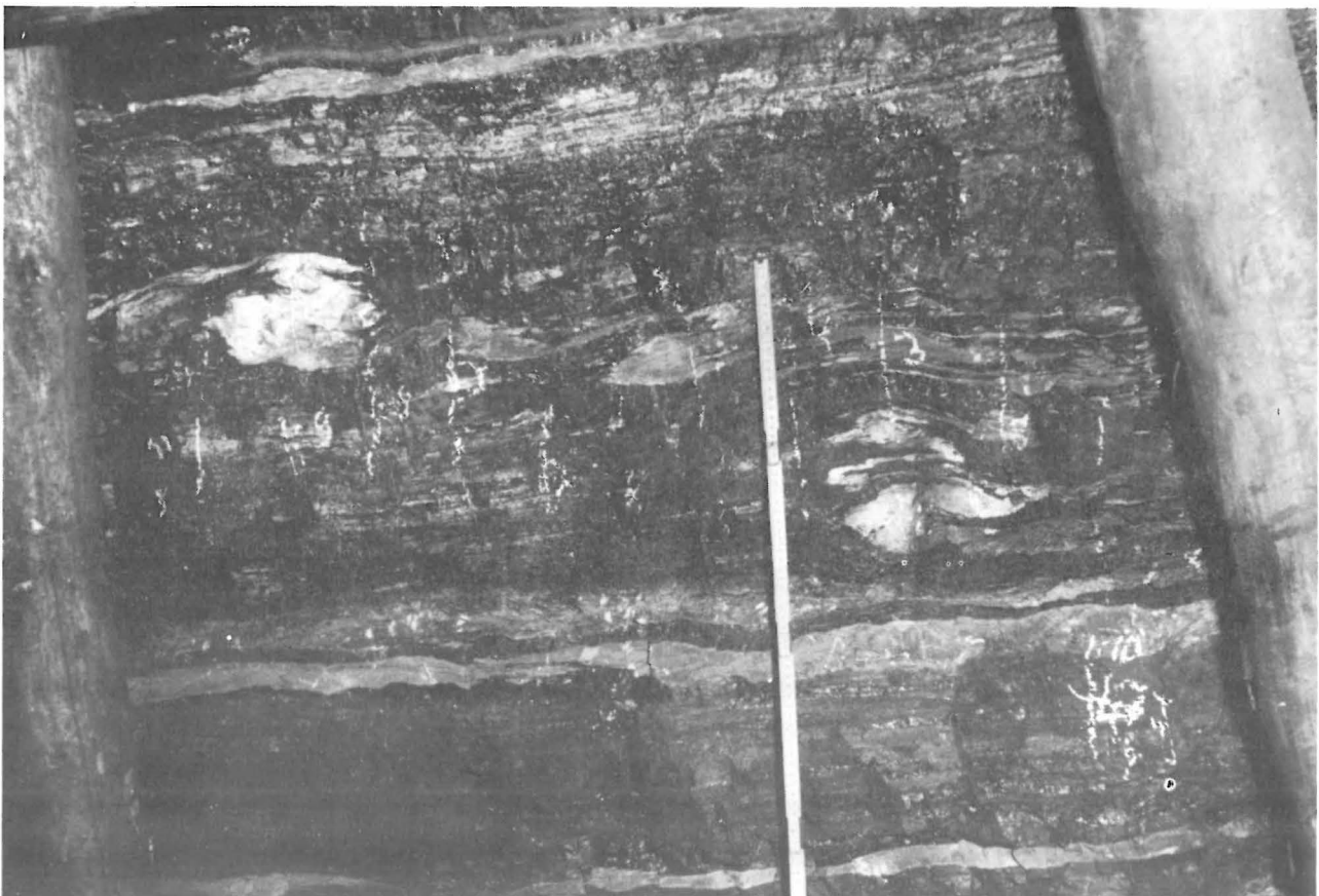
Photo 2 Fließfaltung einer schräg das 5. Flöz durchsetzenden Tonsteinlage. Unten die Lette 5 oder Doppellette, Gittersee.
