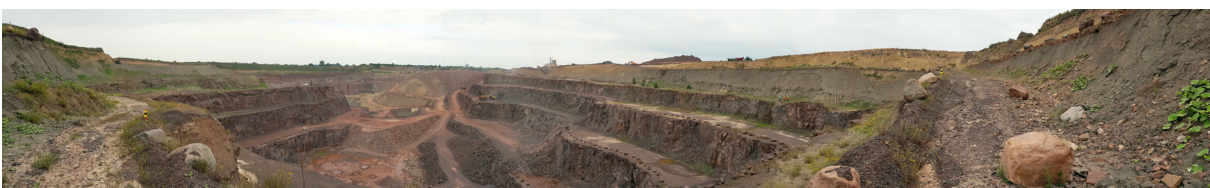
Abb. 1: Blick auf den Steinbruch Mammendorf mit den Abbausohlen des Andesits. Eiszeitliche Moräne (im Bild rechts und links, oberste Sohle) überlagert sowohl den Andesit als auch Sedimentite des Rotliegend oder das tertiäre Konglomerat. Letzteres überlagert seinerseits ebenso den Andesit oder das Rotliegend.
