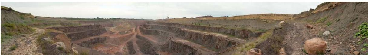
Abb. 1: Blick auf den Steinbruch Mammendorf mit den Abbausohlen des Andesits. Eiszeitliche Moräne (im Bild rechts und links, oberste Sohle) überlagert sowohl den Andesit als auch Sedimentite des Rotliegend oder das tertiäre Konglomerat. Letzteres überlagert seinerseits ebenso den Andesit oder das Rotliegend.
