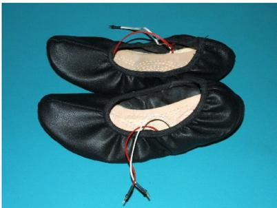
Abbildung 7: Gymnastikschuhe mit Kontakt-Messsohlen
