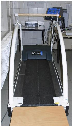
Abbildung 9: Dynamometrisches Laufbandergometer Gaitway®
