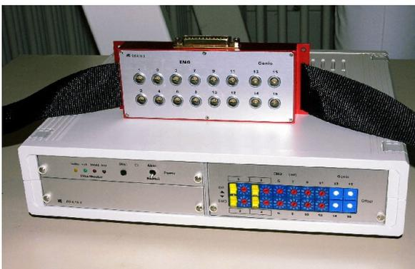
Abbildung 11: Isolationsverstärker (unten) und Probandenverstärker (oben)
