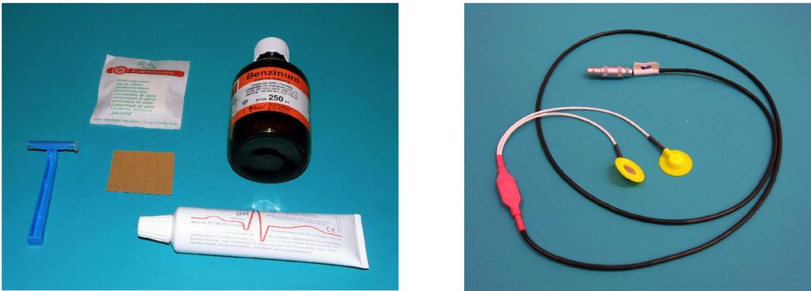
**Abbildung 8: Materialien zur Vorbereitung der Messung und Mehrwegelektroden**
