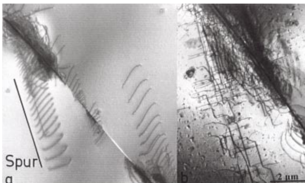
Abbildung 4.26: Verformungsstrukturen entlang des Rissverlaufes nach dem Bruch einer [201]-orientierten Mikrozugprobe in einem In-situ-Dehnexperiment bei 800 °C. a) {110}-Gleitbänder, b) [001]-parallele Versetzungen mit Kinken.
