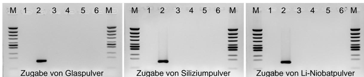
**Abbildung 17** Inverse gelelektrophoretische Aufnahme, die den Einfluss der Zugabe von verschiedenen Mengen Materialpulver auf eine PCR-Reaktionen im Tischthermocycler (Volumen = 100  $\mu$ l) zeigt: links - Zugabe von Glaspulver; mitte - Zugabe von Siliziumpulver; rechts - Zugabe von Li-Niobatpulver
