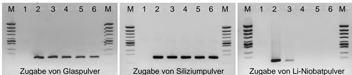
**Abbildung 18** Inverse gelelektrophoretische Aufnahme, die den Einfluss der Zugabe von verschiedenen Mengen Materialpulver in Kombination mit der Verwendung von BSA und Q-Solution als Additive auf eine PCR-Reaktionen im Tischzycler (Volumen = 100  $\mu$ l) zeigt: links - Zugabe von Glaspulver; mitte - Zugabe von Siliziumpulver; rechts - Zugabe von Li-Niobatpulver
