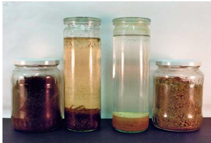
Abbildung 9: Sedimentationsanalyse, Versuchsende (nach 24 h).
