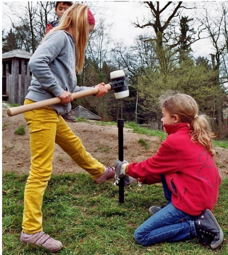
Abbildung 4: Einschlagen des Bohrstabes
