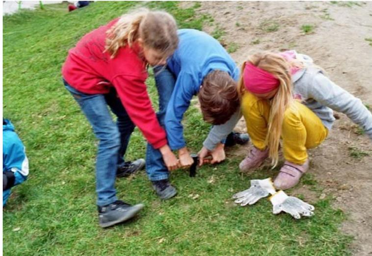
Abbildung 5: Ziehen des Bohrstabes durch Herausdrehen in Teamarbeit
