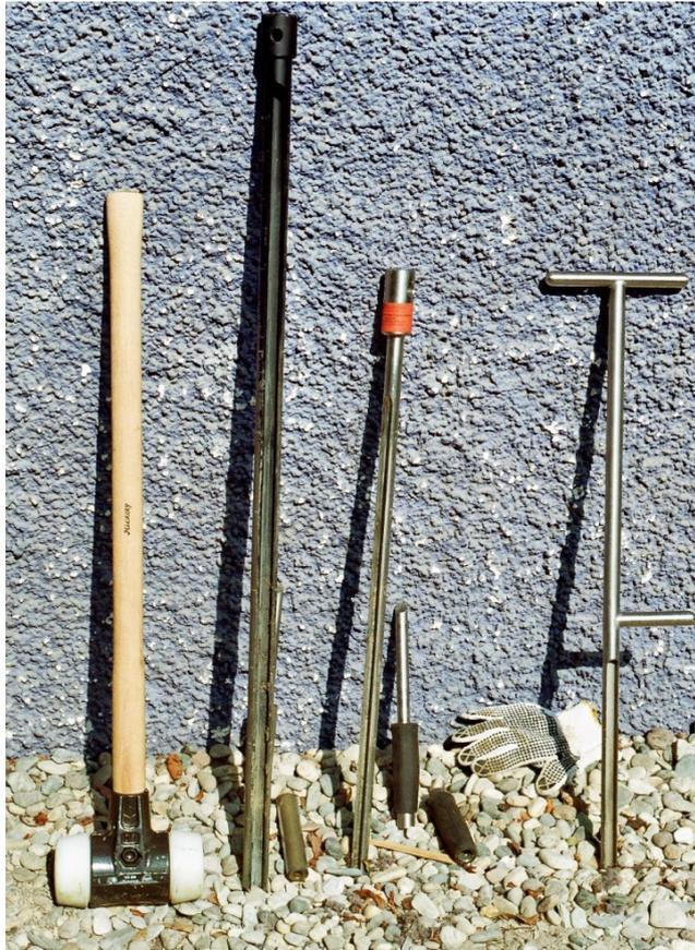
Abbildung 2: Geräte zur Durchführung von Kleinbohrungen: Schonhammer, Bohrstab 1000 mm, Bohrstab 600 mm, Quergriffe, Bohrstab 300 mm mit Fußraste
