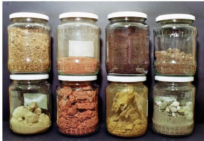
Abbildung 7: Auswahl an lagerfähigen Bodenproben – von links nach rechts: oben: Braunerde, verbrannter Regosol, humoser Auenboden, Auffüllung, unten: Löß, Auflockerungszone Rotliegend, Terra fusca,
