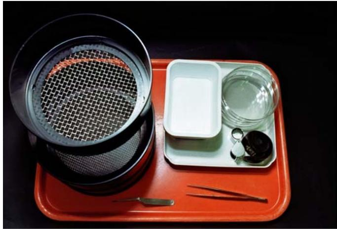
Abbildung 10: Geräte zur Siebanalyse
