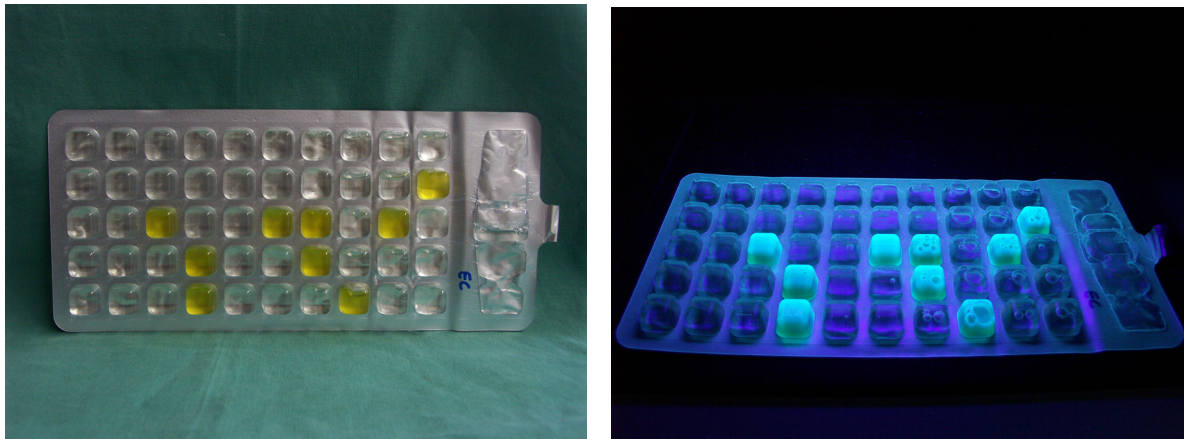
Abb. 3-18: Beispiele für positive Reaktion des Quanti-Tray® Systems – Farbumschlag und Fluoreszenz
