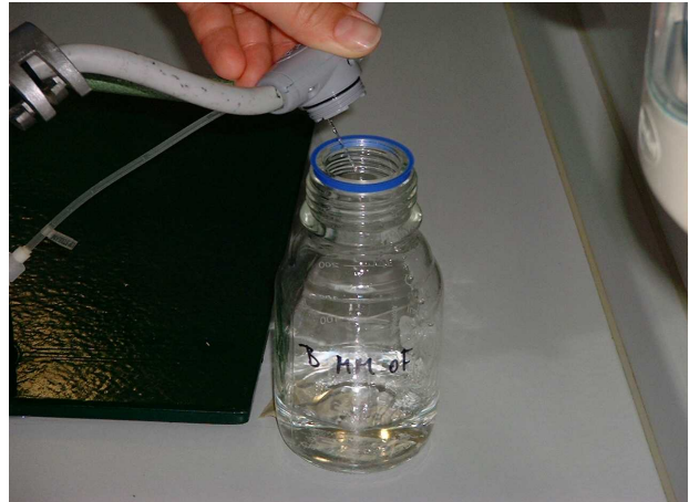
Abb. 3-5: Ablassen des Stagnationswassers aus dem „up-stream“-Bereich
