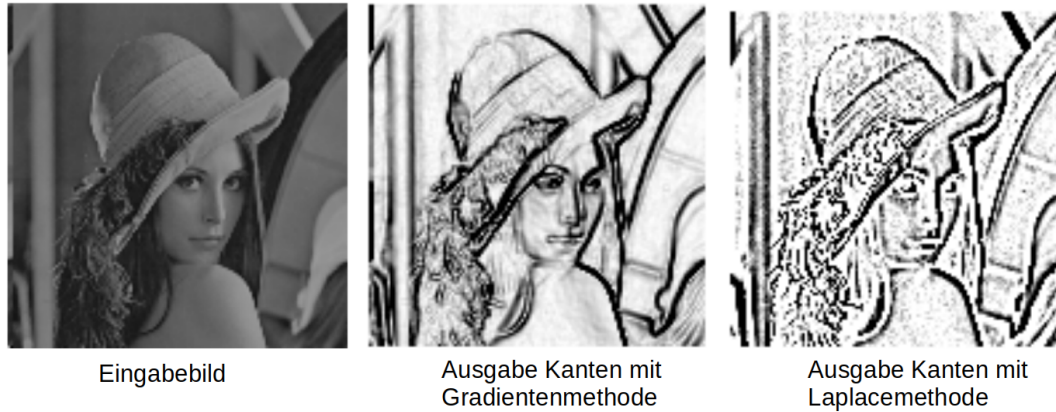
Abbildung 2.6: Beispielhafte Anwendung zweier verschiedener Kantenfilter auf ein Eingabebild. In der Mitte ist ein Beispiel für die Gradientenmethode zu sehen, Rechts die Laplacemethode.
