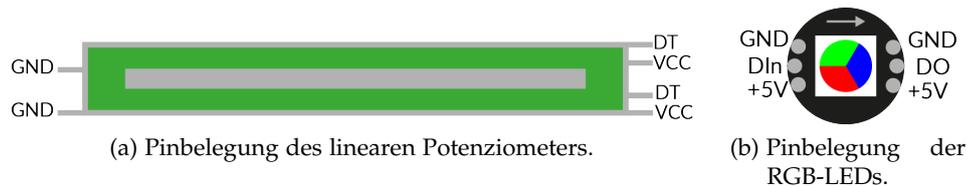
Abbildung 4.15: Visualisierung der Pinbelegung einzelner Komponenten (eigene Abbildung).
