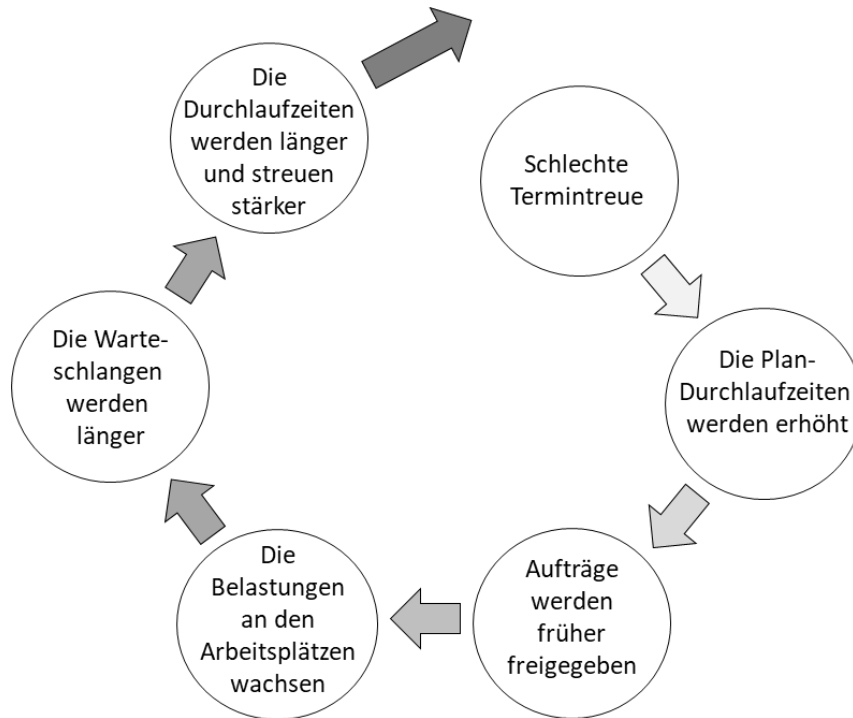
Abbildung 1.3: Fehlerkreis der Produktionssteuerung [Plossl 1973; nach Wiendahl 2010, S. 253]
