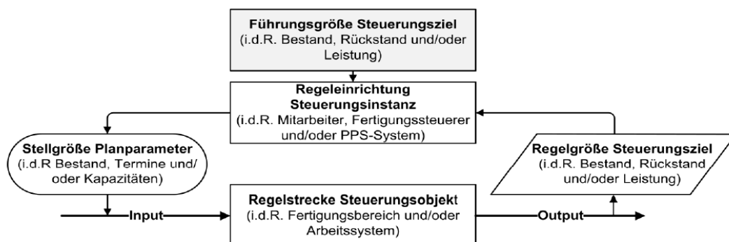
Abbildung 3.2: Modell einer Fertigungsregelung [Kienzle 2011, S. 23]
