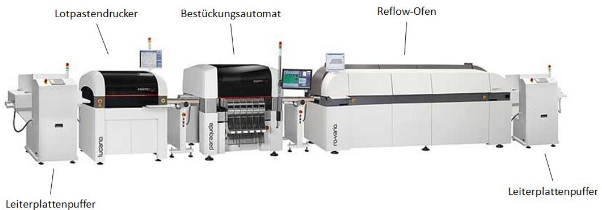
Abbildung 2.10: Beispiel einer SMT-Linie, in Anlehnung an [Torenko & Associates 2017]
