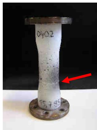
Abb. 4.1 Kollaps einer Zellebene bei Druckbeanspruchung
