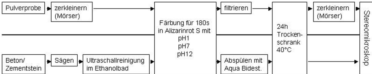
Abbildung 4-1: Präparationsschema zum Färben von Pulverproben bzw. Beton/Zementstein mit ARS
