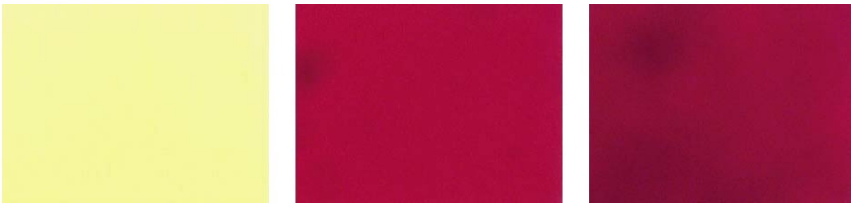
Abbildung 5-1: Alizarinrot S-Lösung bei pH1 ( L=96 , a^*=-13 , b^*=44 ), pH7 ( L=37 , a^*=59 , b^*=18 ) und pH12 ( L=30 , a^*=52 , b^*=11 ) (von links; Lösungszusammensetzung siehe Abschnitt 4.1.1)
