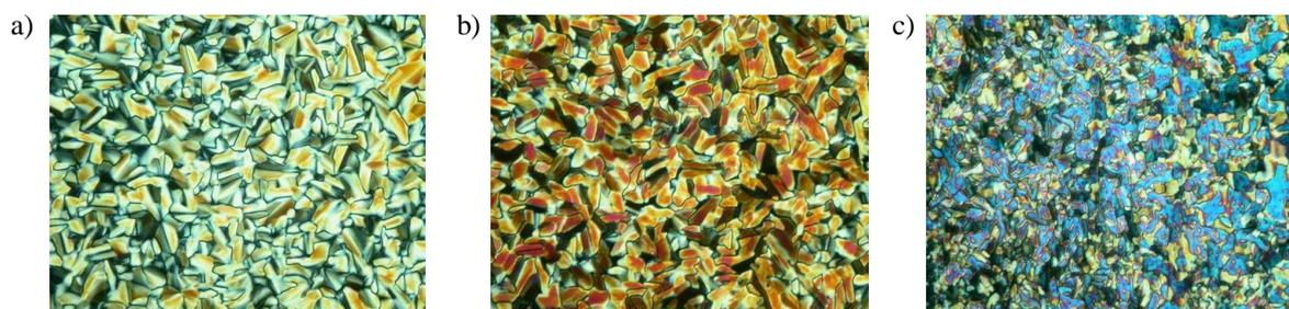
**Abbildung 62:** a) Textur der kolumnaren Phase der Verbindungen **A-14.3**<sub>12/12</sub> bei 164 °C; b,c) Untersuchung des Schaltverhaltens bei 164 °C: b) Textur bei einem Feld von  $E = 100 \text{ V}_{pp} / 6 \mu\text{m}$ ; c) Mosaiktextur bei  $E = 290 \text{ V}_{pp} / 6 \mu\text{m}$ .
