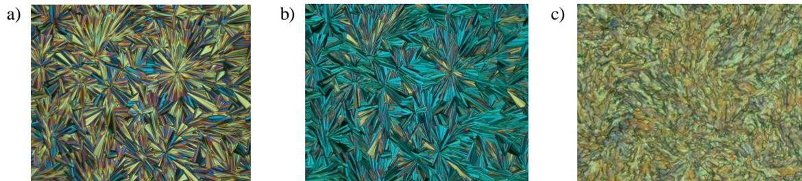
**Abbildung 39:** Polarisationmikroskopische Aufnahme der Textur von **A-1.112/12** bei  $163\text{ °C}$ ; a)  $0 V_{pp}$ ; b,c) nach Anlegen einer Dreiecksspannung von b)  $U = 100 V_{pp}$ , nach  $t = 2\text{ min}$ ,  $d_{Zelle} = 6\mu\text{m}$ ; c)  $U = 200 V_{pp}$ ,  $d_{Zelle} = 6\mu\text{m}$ .
