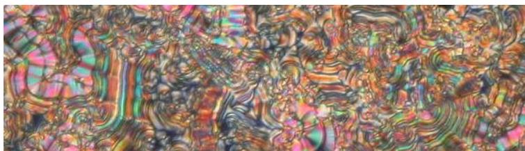
**Abbildung 82:** Polarisationsmikroskopische Aufnahme der Textur von Verbindung **o-OH 2.1** bei 126 °C.
