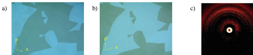
**Abbildung 93:** a,b) Polarisationsmikroskopische Aufnahme der Textur der Verbindung **o-OH 5.4** bei 122 °C; Polarisator und Analysator sind um a) -8° und b) +8° aus der gekreuzten Position ausgelenkt; c) Röntgendiffraktogramm von **o-OH 5.4** bei 110 °C nach Abzug der Streuung der isotropen Phase (129 °C).
