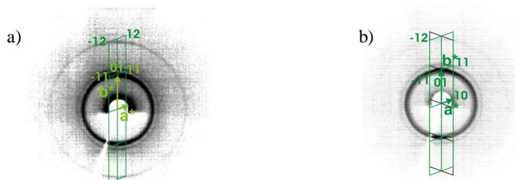
**Abbildung 96:** Röntgendiffraktogramm von teilorientierten Proben von a) Verbindung **o-OH 5.7** bei 150 °C und b) Verbindung **OH 5.6** bei 158 °C, indiziert nach einem schiefwinkligen 2D-Gitter (Für **o-OH 5.7** ist nur eine Orientierung des reziproken Gitters (grüne Linien) dargestellt, für **OH 5.6** die beiden häufigsten (grüne bzw. schwarze Linien) für die teilorientierte Probe).
