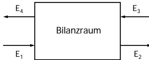
Abbildung 2.4: Bilanzraum um einen Wärmeübertrager
