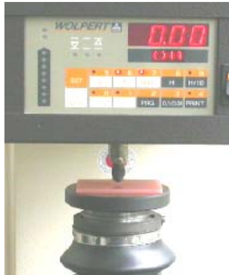
Abbildung 5: Makrohärteprüfmaschine K-Testor 2524 (Instron-Wolpert, Darmstadt, Deutschland)
