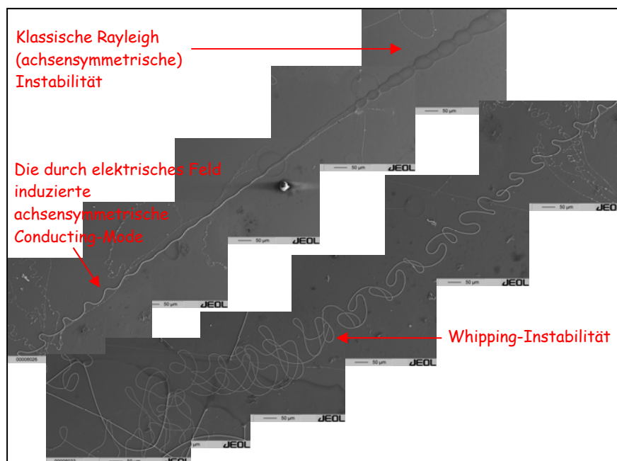
Abbildung III.-4: Entwicklung eines Jets während des Elektrosplein-Vorganges von 2 Gew.-% PEO in Chloroform
