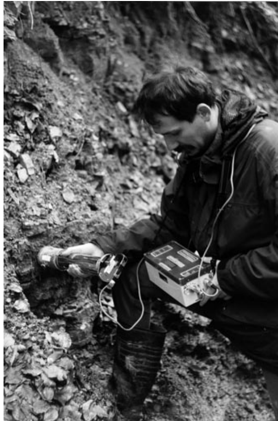
Abb. 2: Messung mit der Gamma-Sonde im Gelände.
