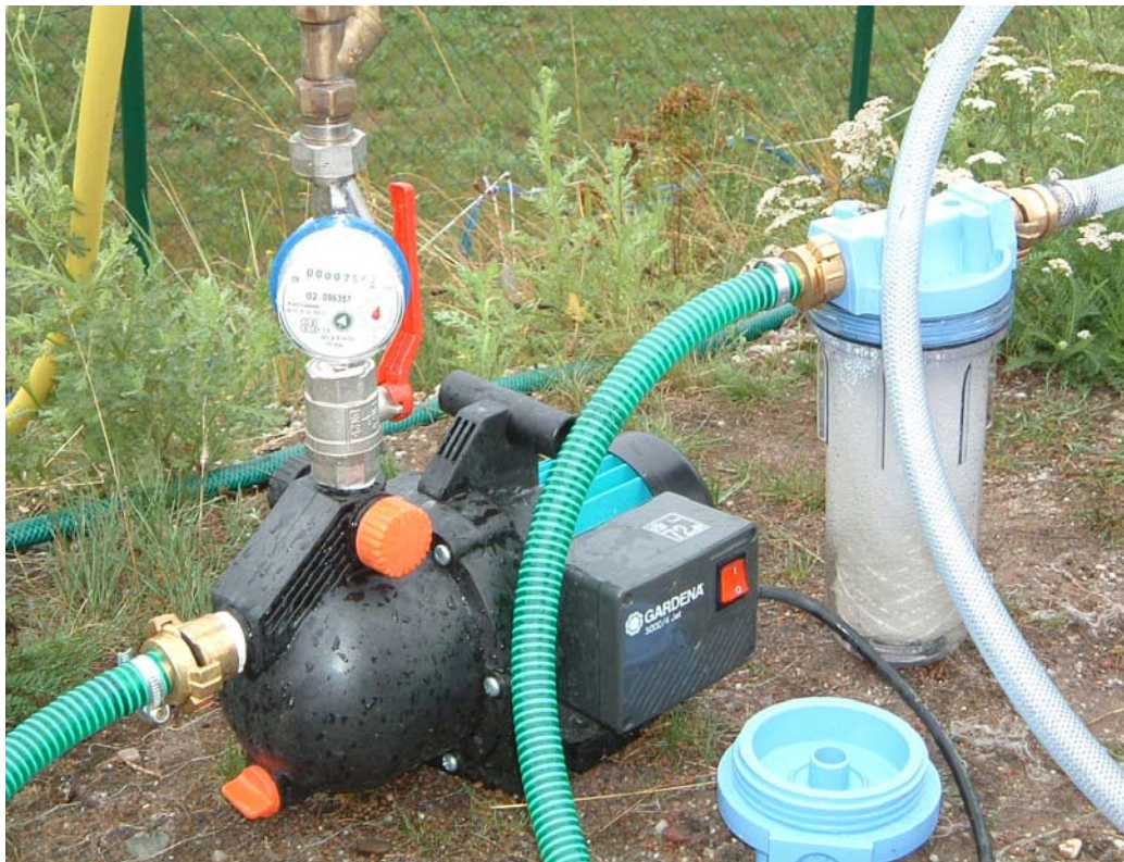
Abb. 9: Geräteaufbau zur parasitologischen Probenahme (Pumpe und Wasseruhr sind dem Filtergehäuse nachgeschaltet)
