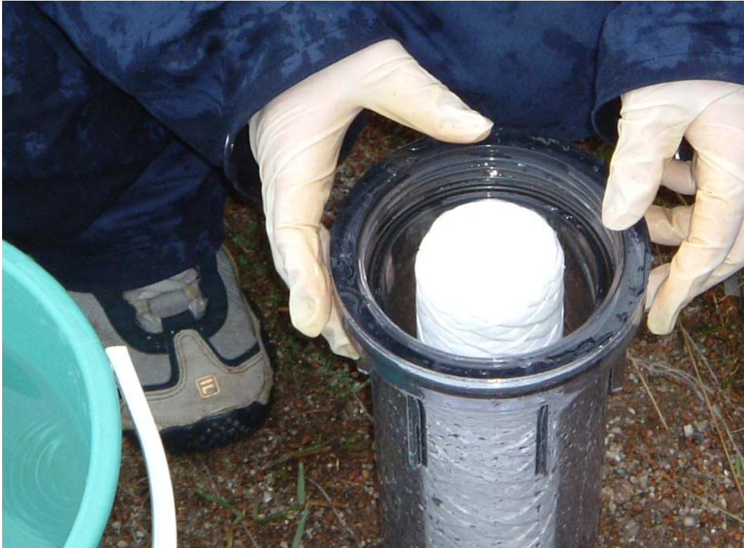
Abb. 10: Bestücken der Filterpatrone mit einem Wickelfilter, nominale Porenweite 1 \mu\text{m} .
