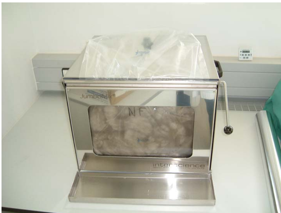
Abb. 12: Homogenisierer Stomacher Jumbomix ® (Inter-science, St. Nom, Frankreich)
