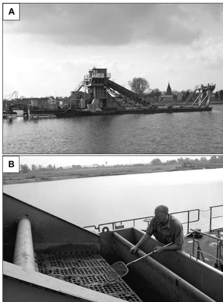
Abb. 1 (A) Eimerketten-Schwimmbagger auf dem künstlich geschaffenen See östlich von Barleben (im Hintergrund Barlebener Dorfkirche). (B) Einer der Autoren am Rüttelsieb beim Aufsammeln von Schwefelkiesknollen.
