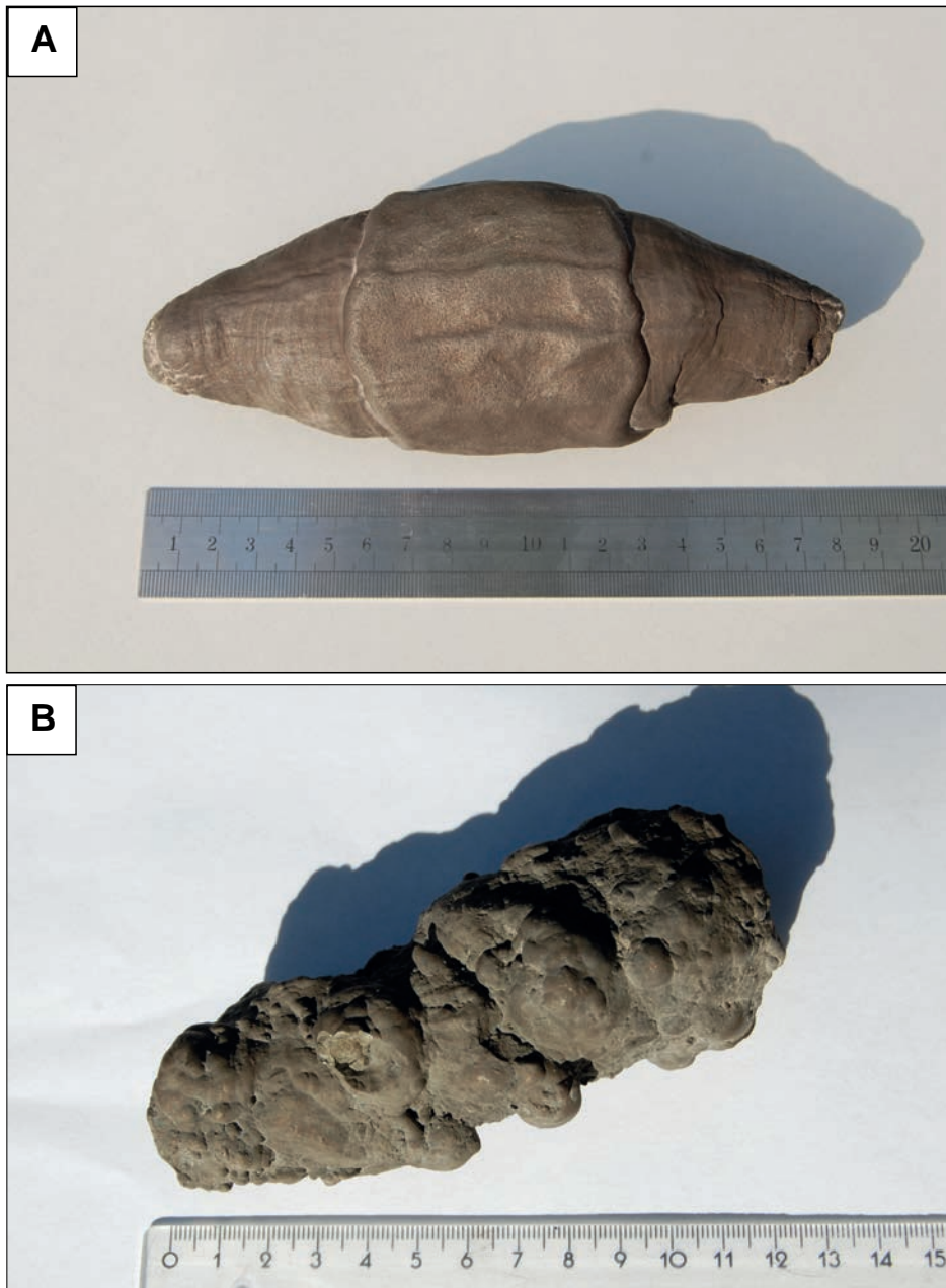
Abb. 7 (A) Eisensulfid-Konkretion gefunden 2010 von H. Märtens (1,28 kg). (B) Stalaktitförmiges Fundstück mit knolliger Oberfläche und matt-bronzefarbenem Oberflächenglanz. Bei beiden Objekten handelt es sich wahrscheinlich um markasitisiertes / pyritisiertes Holz.
