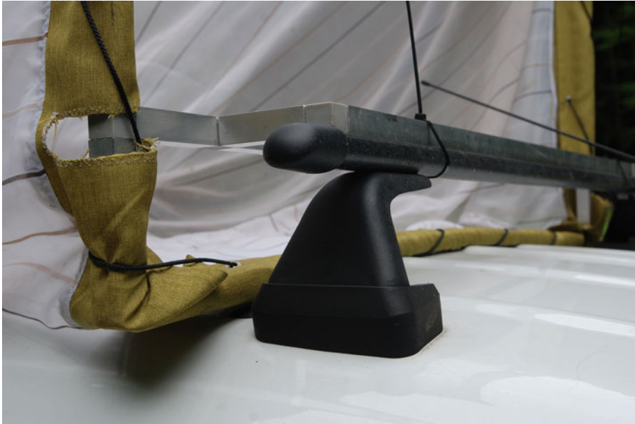
Abb. 4 Befestigung des Keschernetzes am Aluminiumrahmen der Keschter-Öffnung (Foto: T. Glinka).
