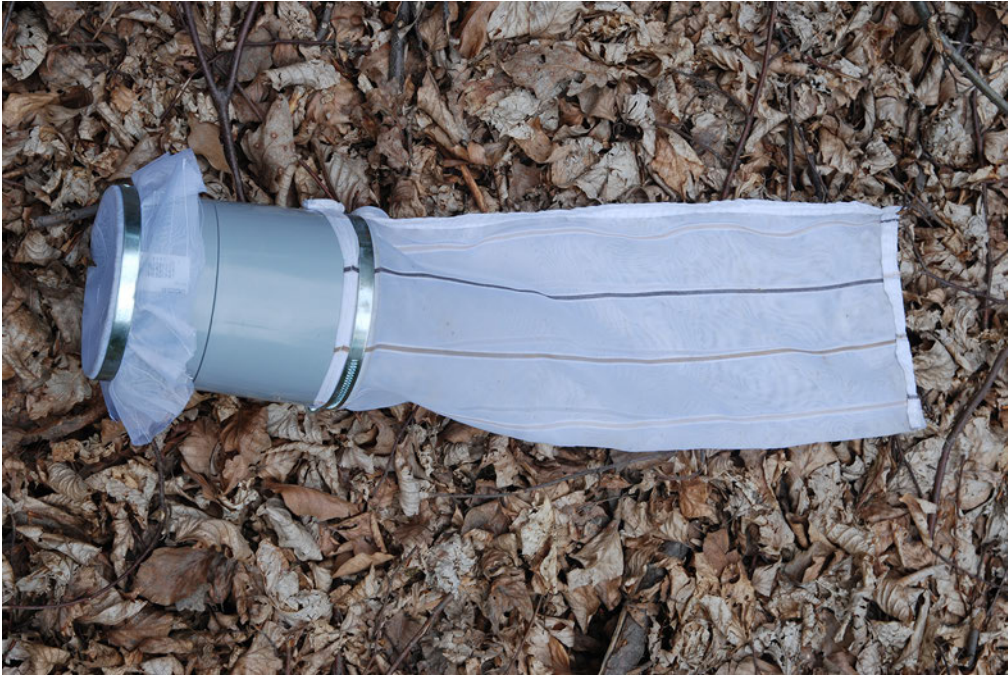
Abb. 9 Mit Verschlusskappe verschlossener Netzaufsatz (Foto: T. Glinka).
