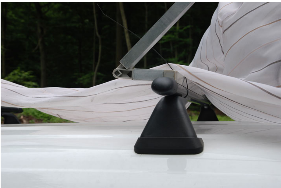
Abb. 5 Befestigung des Querholms auf dem mittleren Dachträger (Foto: T. Glinka).
