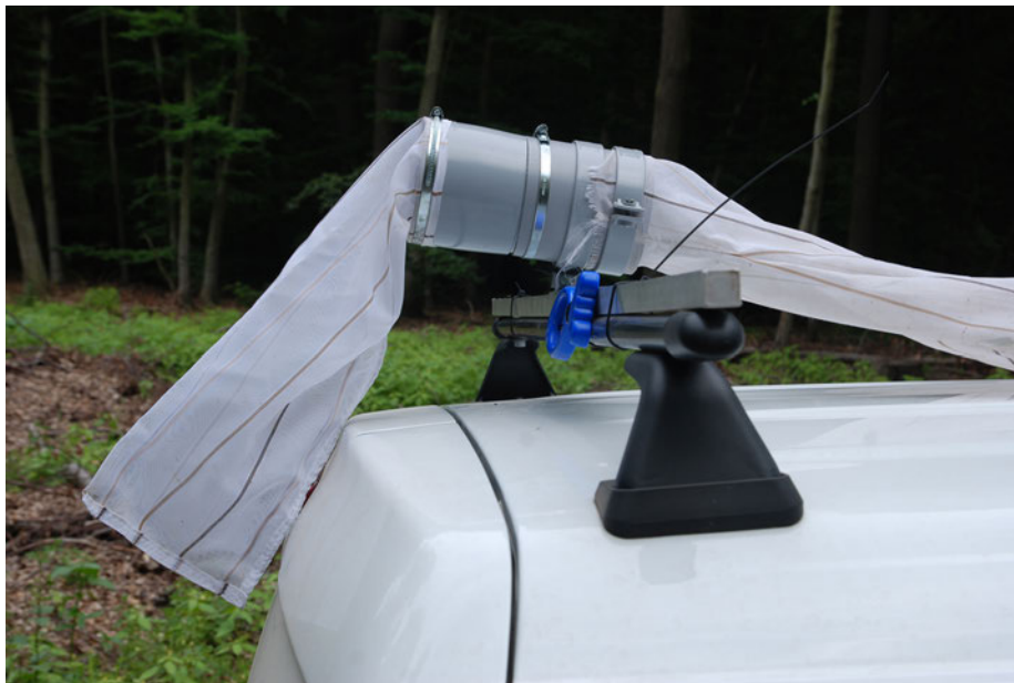
Abb. 7 Aufnahmestück am Kescherende mit Keschnetz (rechts) und angebrachtem Aufsatz (links) (Foto: T. Glinka).
