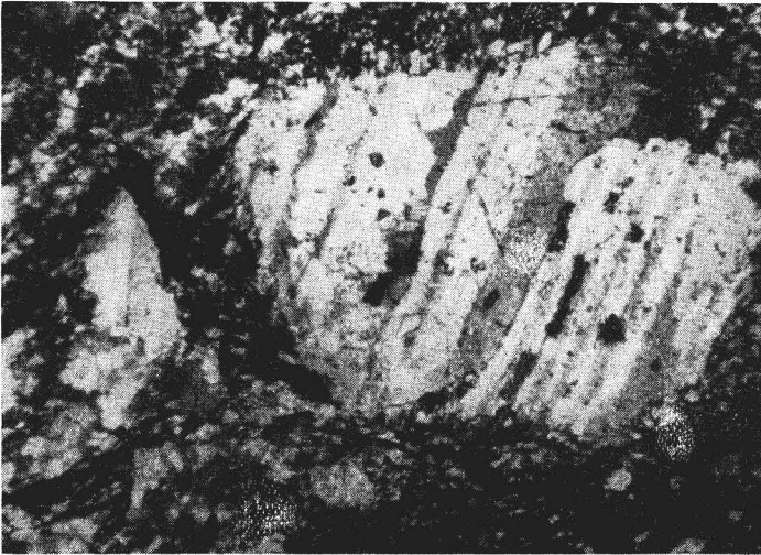
Abb. 6. Reliktischer Plagioklaseinsprengling, von Serizit und Epidot überstäubt und randlich von Grundmasse verdrängt Forstort Gehren, Ostseite + Nic, Vergr. 25
