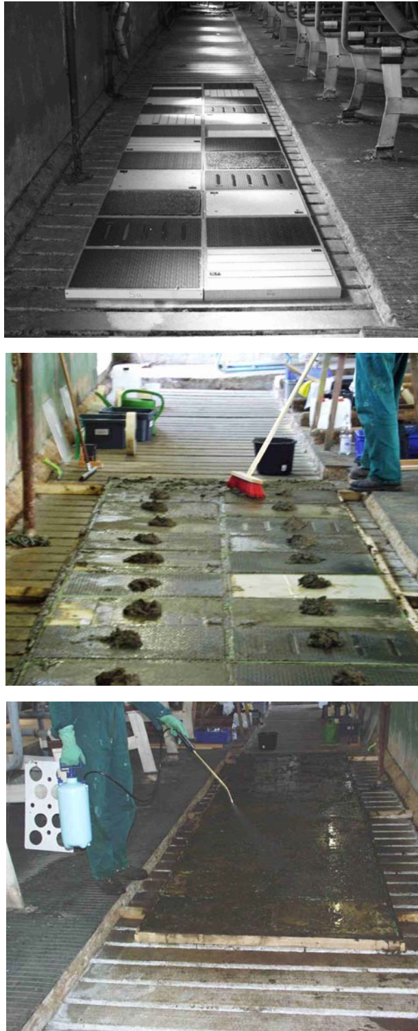
Abb. A 17: Anordnung der Versuchsbodenbeläge zur Vorkonditionierung in laborähnlicher Umgebung (Anbindestall Versuchsstation 401) (Oben), Verteilung der Exkremente (Mitte), Applikation von Harnstofflösung (Unten) (Versuche 2004)
