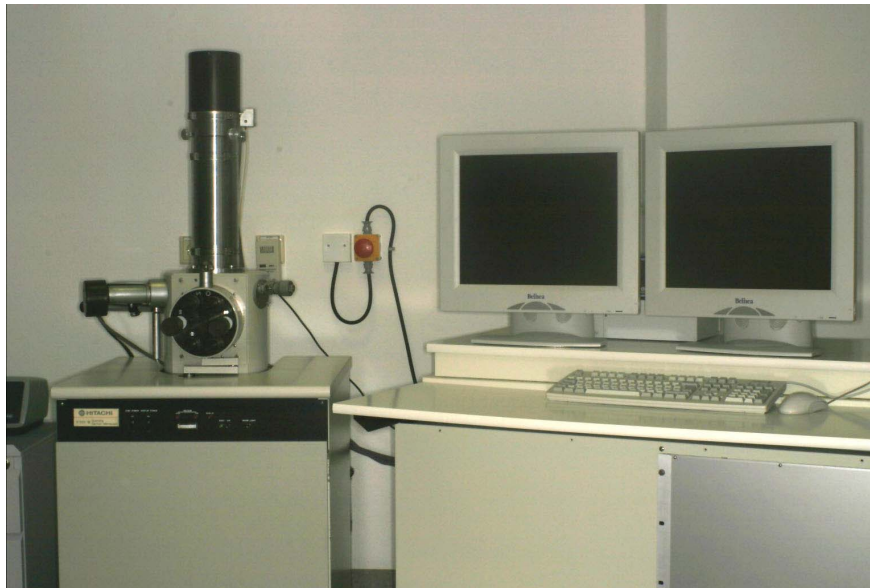
Abb.13: Rasterelektronenmikroskop(REM) zur Beurteilung der Randqualität
