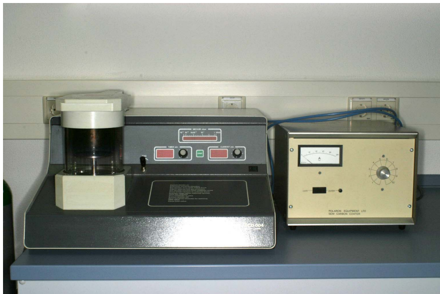
Abb.12: Sputtergerät zum Bedampfen der Replika
